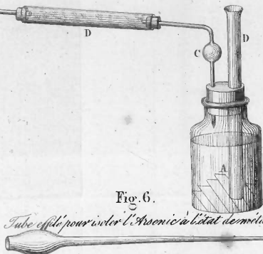
Fig. 5. Disposition pour isoler l'Arsenic dans l'appareil de Marsh.
