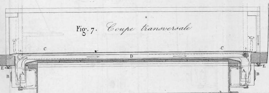
*Chauffage par le gaz, système Chaumont. (fig. 7 et 8.)*
