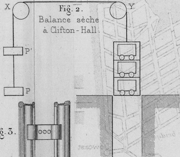
Fig. 3. Guideage en rails à patin à Bickershaw.
